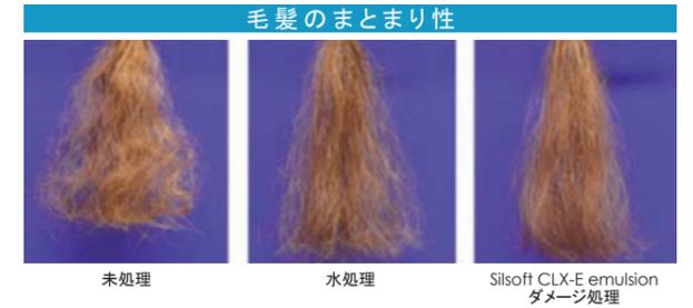
Silsoft CLX-E emulsion (固形分換算 1% 水溶液) を塗布乾燥後、ヘアアイロン (234°C) に 6 回通し、ラウレス硫酸ナトリウム溶液で 10 回洗髪、乾燥後、湿度 90% の環境下で 1 時間後の毛髪外観を観察した。Silsoft CLX-E emulsion で処理した毛髪はまとまり性を改善することが確認出来た。
