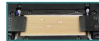
Silsoft CLX-E emulsion (固形分換算 0.25% 水溶液) で一度のみ処理した毛髪を 10% ラウリルエーテル硫酸ナトリウム水溶液で毛髪を洗髪、すすぎ、乾燥後、試験毛髪を画像 1 のようにならべ、水を垂らし、水滴が浸透しなくなるまでの秒数を計測した。この操作を 30 回繰り返し、耐性を確認した。
