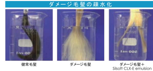
それぞれの毛束を水中に入れ、状態を確認した。ダメージ毛髪は親水性である為、水中で濡れ拡がりますが、Silsoft CLX-E emulsion で処理したダメージ毛髪は健康毛髪のような疎水性が得られます。(Silsoft CLX-E emulsion 固形分換算 1% 水溶液に浸漬後、乾燥処理した毛束にて試験実施)
