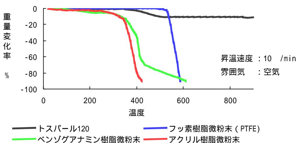
トスパール 120とフッ素樹脂微粒子の示差熱分析結果を、下に示します。
